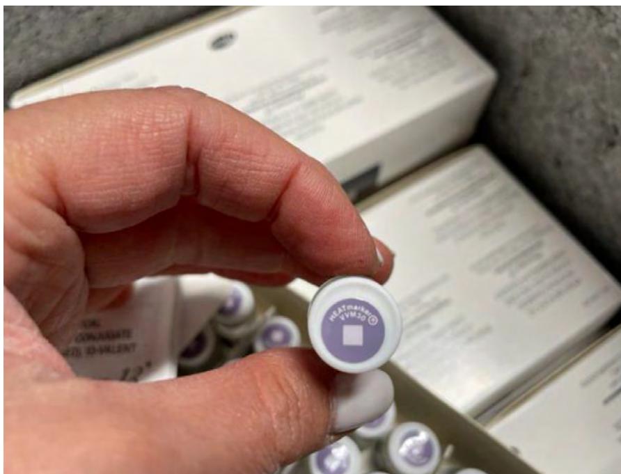
Figura 3 Monitor de frasco de vacina (MFV) indicando que o frasco de vacina ainda pode ser utilizado, já que a cor do quadrado central é mais clara que a do círculo externo
